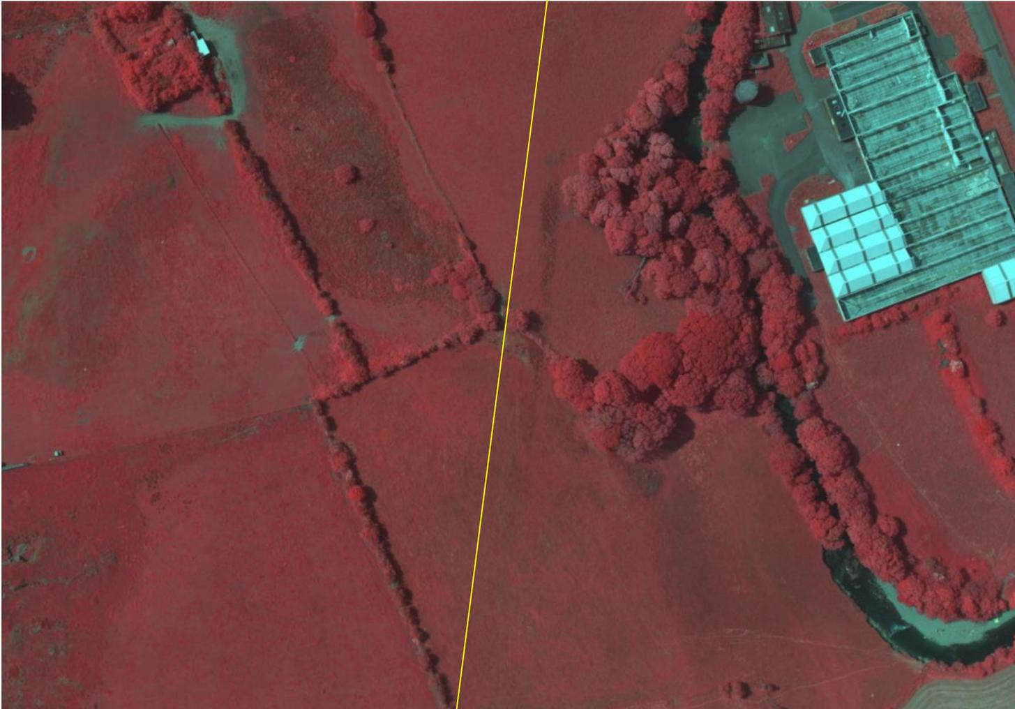
Detektion eines Lecks in einer Wasserleitung - Quelle: Dr. T. Coppack, APEM 2016
